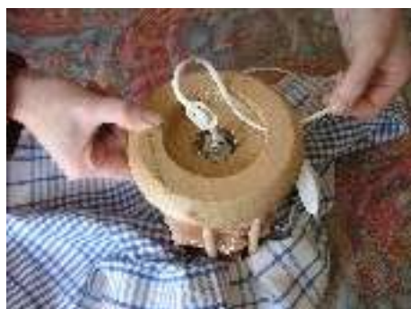
8 - .. enfoncez complètement, la douille puis tirez de nouveau sur le fil d'alimentation électrique.
